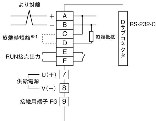
※1、より対線の伝送ラインが終端の場合は(=渡り配線がない場合)、端子C、D間を付属のショートチップ(または配線)で短絡して下さい。ユニットが伝送ラインの途中に配線されているときは、端子C、D間のショートチップをはずして下さい。
