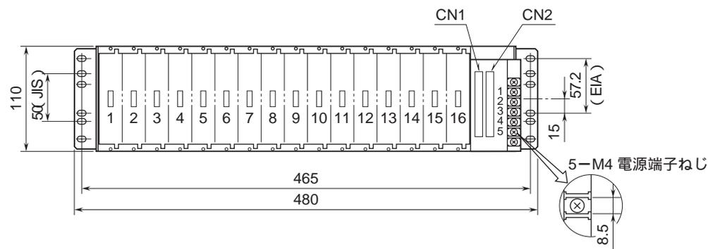
**取付寸法図 (単位: mm)**
