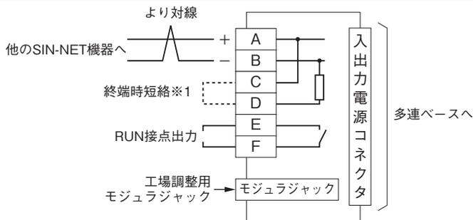
※1、より対線の伝送ラインが終端の場合は (= 渡り配線がない場合)、端子C、D間を付属のショートチップ (または配線) で短絡して下さい。ユニットが伝送ラインの途中に配線されているときは、端子C、D間のショートチップをはずして下さい。
