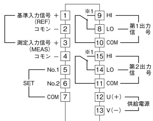
※1、出力形式コード "1" のときの電源OFF時の接点状態です。
