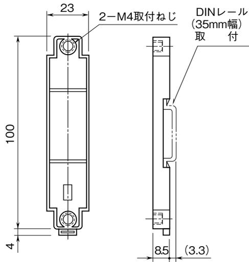
取付寸法図 (単位: mm)
