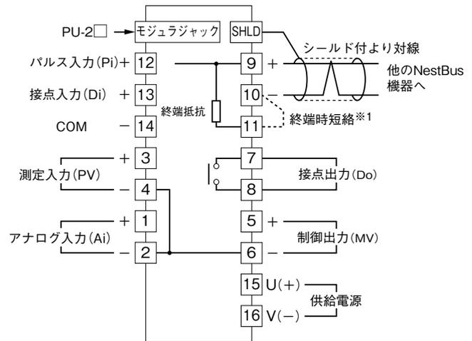
※1、より対線の伝送ラインが終端の場合は (= 渡り配線がない場合)、端子 10、11 間を付属のショートバー (または配線) で短絡して下さい。ユニットが伝送ラインの途中に配線されているときは、端子 10、11 間のショートバーをはずして下さい。
