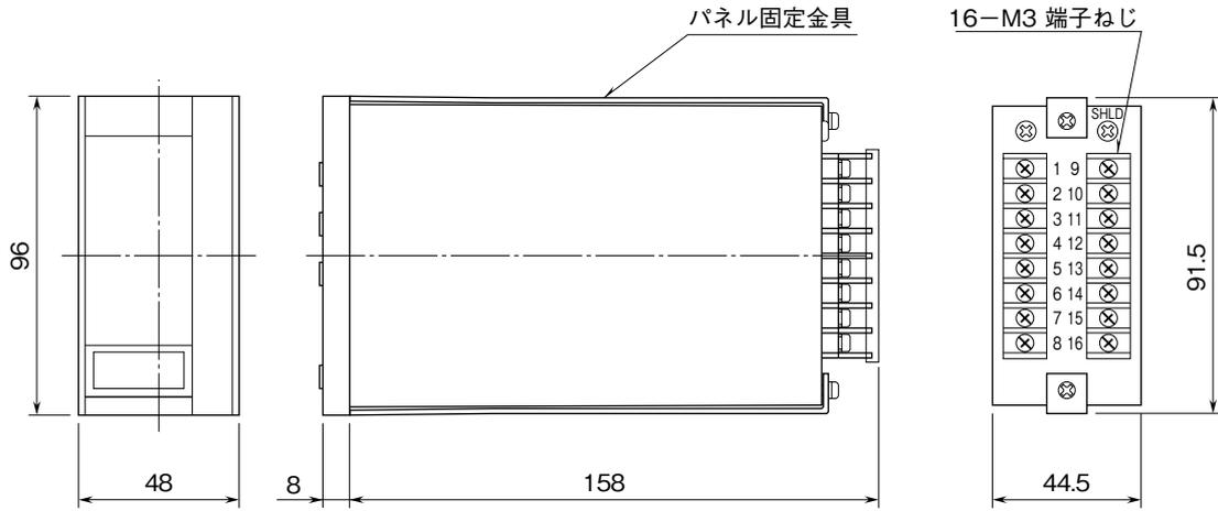
取付寸法図 (単位: mm)
