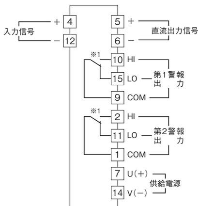
※1、警報出力形式コード“1、4”のときの電源OFF時の接点状態です。
