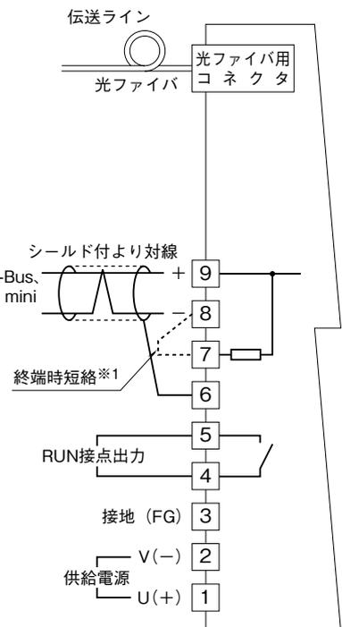
※1、より対線の伝送ラインが終端の場合は (= 渡り配線がない場合)、端子7、8間を付属のショートチップ (または配線) で短絡して下さい。
