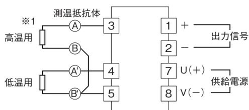
※1、測温抵抗体の接続は、必ず3番端子に高温用を接続して下さい。
