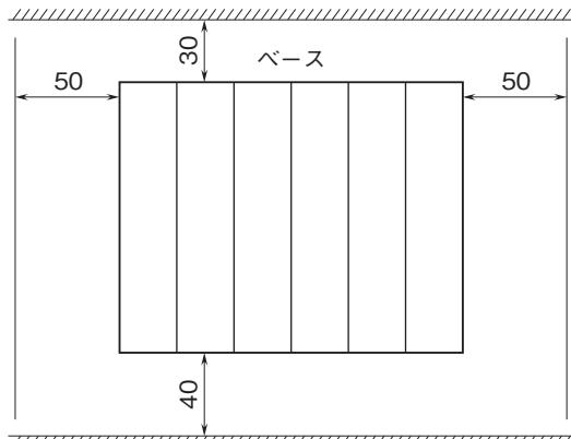
盤の底板、配線ダクト（高さ50mm以下）を示す。
