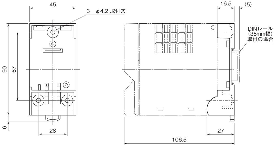
注) DINレール取付を行う場合は、オムロン製 エンドプレート (形式: PFP-M)、IDEC製 止め金具 (形式: BNL6) などの固定金具のご使用をおすすめします。
