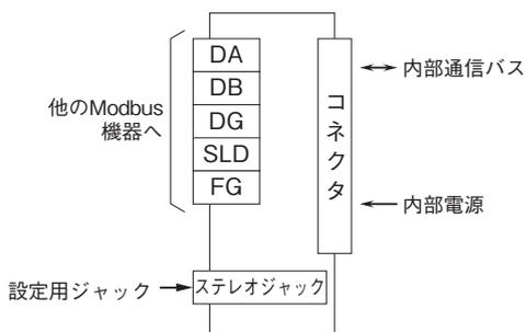
注) FG端子と電源カード(形式:D5-PS)のFGは接続していません。
