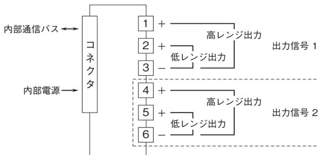
注) 同一チャンネル内で高レンジ出力と低レンジ出力を同時に接続しないで下さい。
