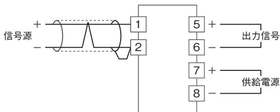
注) 本器は超高速形のため原理的に測定範囲内の周波数成分の入力信号に含まれるノイズだけを変換器内で減衰させることはできません。したがって 'シールド付より対線' を使用するなど入力信号にノイズが混入しないように十分ご注意ください。
