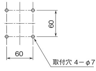
パネル推奨厚み: 1 ~ 4mm (付属ボルト使用の場合)
