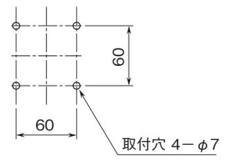
パネル推奨厚み：1～4mm (付属ボルト使用の場合)
