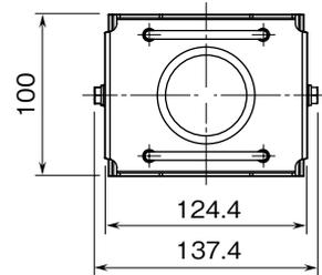
取付寸法図 (単位: mm)
