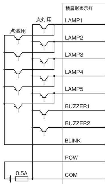
注1) ランプの点灯入力(点灯用)と点滅入力(点滅用)を同時にONした場合、故障しますので絶対に行わないで下さい。
