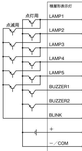
注1、ランプの点灯入力(点灯用)と点滅入力(点滅用)を同時にONした場合、点灯入力が優先されます。
