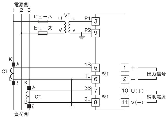
入力電圧回路の電圧が比較的安定しており、補助電源の仕様を満足する場合には、入力電圧回路から供給することも可能です。
