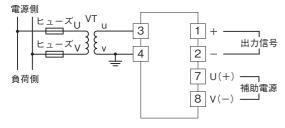
入力電圧回路の電圧が比較的安定しており、補助電源の 仕様を満足する場合には、入力電圧回路から供給することも可能です。
