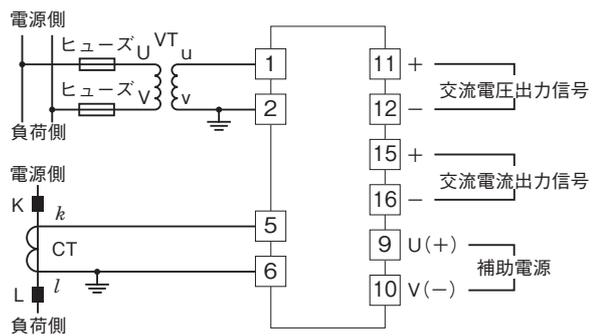
入力電圧が比較的安定しており、仕様書または取扱説明書に記載された補助電源電圧の範囲内であれば、入力電圧からの電源供給が可能です。
