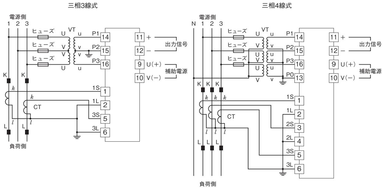
入力電圧が比較的安定しており、仕様書または取扱説明書に記載された補助電源電圧の範囲内であれば、入力電圧からの電源供給が可能です。
