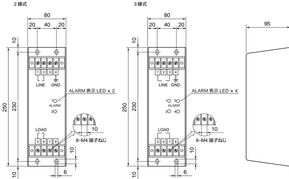
取付寸法図 (単位 : mm)
