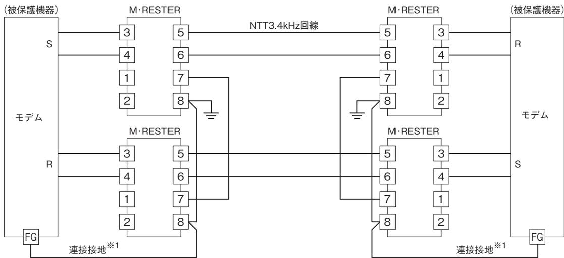
※1、必ず接続接地を施して下さい。被保護機器に接地端子がない場合は、本器のみ接地して下さい。
