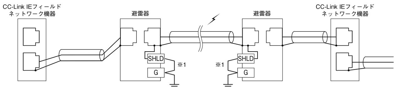
※1、ショートバーが取付られているときは、LANケーブルのシールド (SHLD) はグラウンディング状態です。シールド付LANケーブルをご使用の場合は、必ずショートバーを取付けて下さい。
