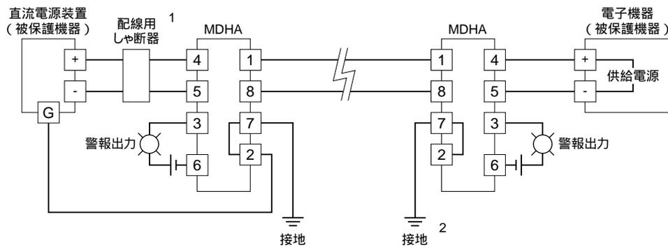
1. 配線用しゃ断器は必ず設置して下さい。
