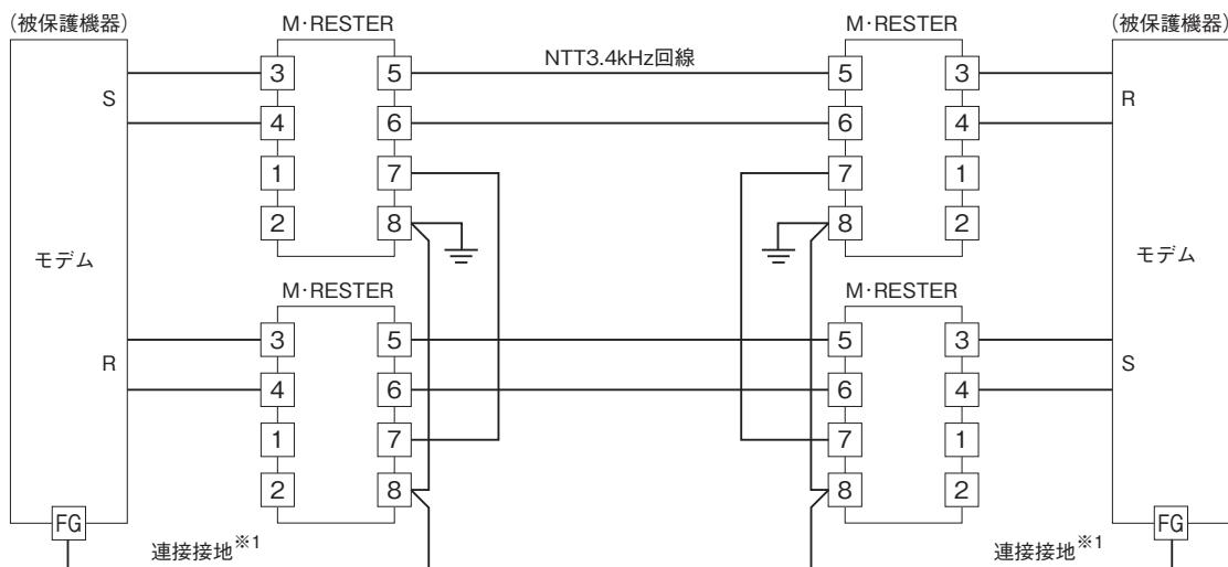
※1、必ず連接接地を施して下さい。被保護機器に接地端子がない場合は、本器のみ接地して下さい。
