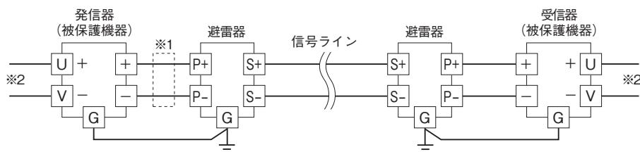
※1、発信器の出力容量が100mAを超える場合、サーキットプロテクタを設置して下さい。
