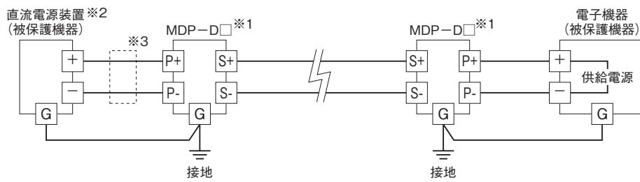
※1、本器は2線式伝送路の保護用には使用できません。2線式伝送路の保護用には洩れ電流を抑えた標準信号用避雷器MDP-24-1をご使用下さい。本器を接続する際、極性を確認して下さい。誤った接続をすると、内部の電圧制限素子が破壊する恐れがあります。
