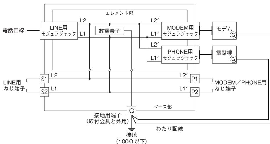
※モデム、電話機のG端子は必ずMDP-TLの接地用端子へわたり配線して下さい。
