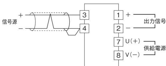
注) 本器は微小信号入力時に大きな増幅度となっているため、入力信号に含まれるノイズにより出力が不安定となる可能性があります。したがって 'シールド付より対線' を使用するなど入力信号にノイズが混入しないように十分ご注意ください。
