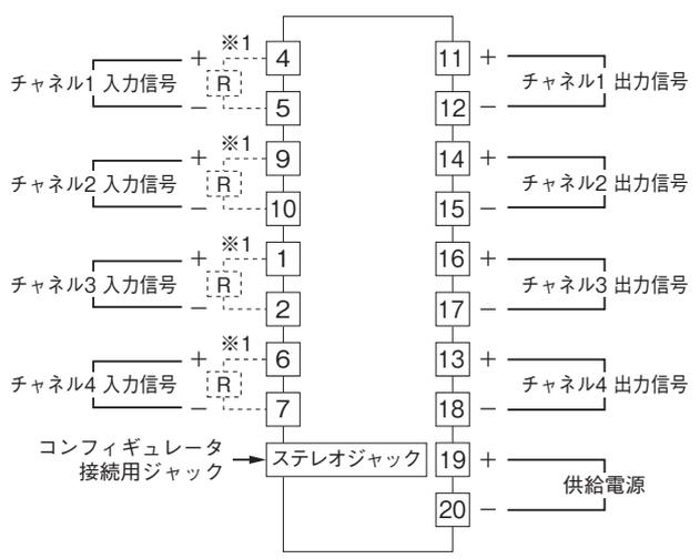
※1、電流入力時は入力抵抗器 (R) を取付けて下さい。
