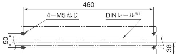
※1、DINレールは水平に取付けて下さい。
