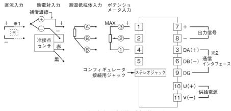
※1、電流入力時は入力抵抗器(R)が付きます。 ※2、通信インタフェースがRS-485ラインの終端になる場合は、Modbus通信用 終端抵抗スイッチをONに、それ以外の場合はOFFにして下さい。
