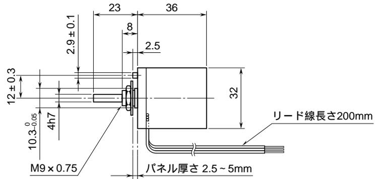
取付寸法図 (単位: mm)
