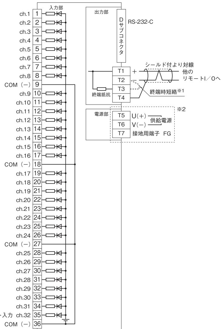
※1、より対線の伝送ラインが終端の場合は(=渡り配線がない場合)、端子T2、T3間に付属のショートチップ(または配線)で短絡して下さい。ユニットが伝送ラインの途中に配線されているときは、端子T2、T3間のショートチップをはずして下さい。
