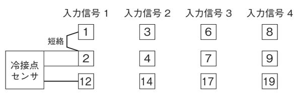
未使用の入力端子が短絡されていない場合、ERR表示ランプが赤色に点灯し、PLC等にバーンアウトフラグがセットされます。入力を短絡すると、入力値はほぼ室温となります。この値で警報が出力されないように警報設定値を設定して下さい。コンフィギュレータソフトウェア (形式:R3CON) を用いることにより、未使用入力の処理を行わずに、未使用入力の設定が可能です。
