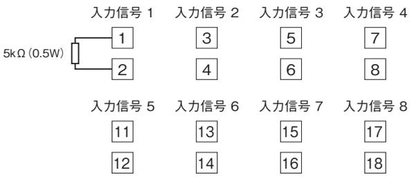
未使用の入力端子に抵抗が接続されていない場合、入力が-15%以下となり、PLC等にデータ異常がセットされます。
