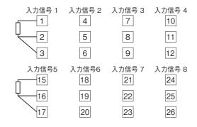
未使用の入力端子に抵抗器が接続されていない場合、ERR表示ランプが赤色に 点灯し、PLC等にバーンアウトフラグがセットされます。 コンフィギュレータソフトウェア(形式:R3CON)を用いることにより、未 使用入力の処理を行わずに未使用入力の設定が可能です。
