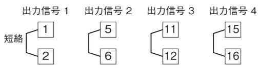
未使用の出力端子が短絡されていない場合、ERR表示ランプが赤色に点灯し、PLC等に断線フラグがセットされます。
