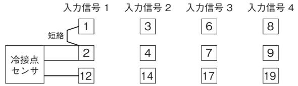
未使用の入力端子が短絡されていない場合、ERR表示ランプが赤色に点灯し、PLC等にバーンアウトフラグがセットされます。
