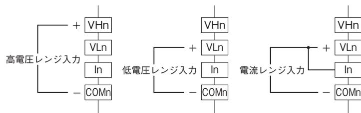
注) 直流電流入力時は必ず VLn と In 端子を短絡してご使用下さい。
