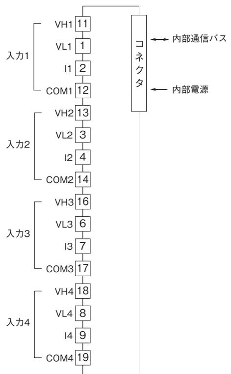
注) 同一チャンネル内で高電圧レンジ、低電圧レンジ、電流レンジを同時に接続しないで下さい。
