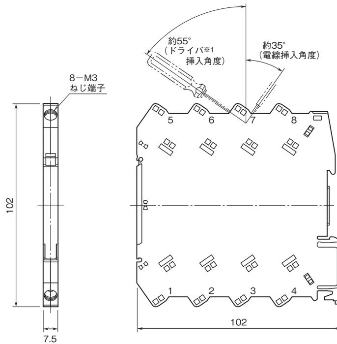
※1、ドライバの軸径は、6mm以下のものを使用して下さい。
