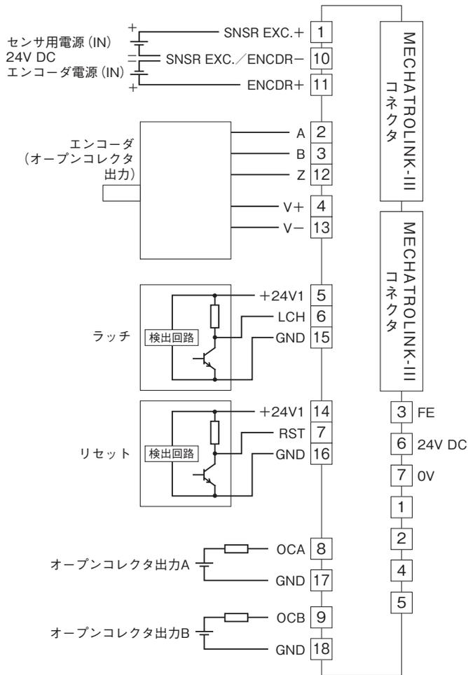
注) エンコーダ入力の配線はシールド付より対線を使用し、シールドは必ず接地して下さい。
