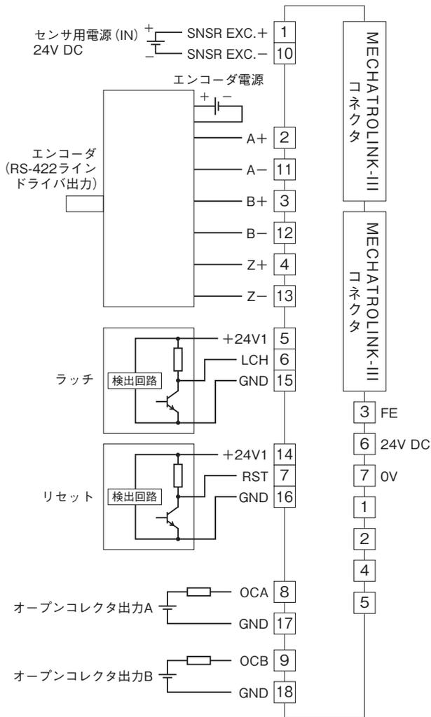
注) エンコーダ入力の配線はシールド付より対線を使用し、シールドは必ず接地して下さい。
