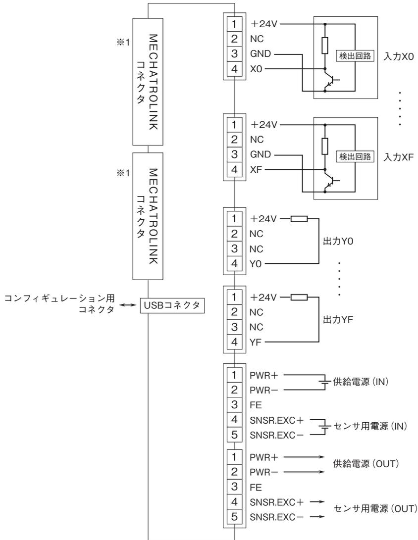
※1、MECHATROLINKコネクタは内部で接続されていますので、通信ケーブルはどちらにも接続できます。
