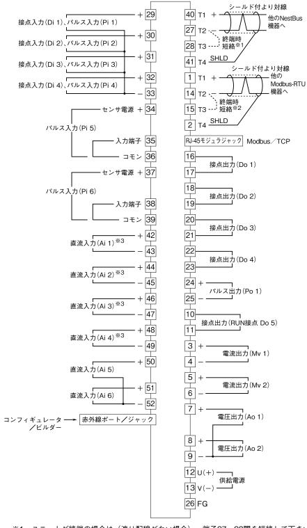
%1、ユニットが終端の場合は(渡り配線がない場合)、端子27、28間を短絡して下さい。 %2、ユニットが終端の場合は(渡り配線がない場合)、端子14、15間を短絡して下さい。 %3、電流入力時は抵抗モジュール(形式:REM4)を取付けて使用します。(Ai1 $\sim$ Ai4)
