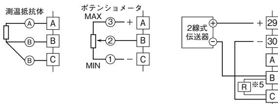
※3、電流入力時は抵抗モジュール（形式：REM4）を取付けて使用します。
