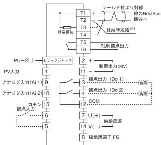
※1、より対線の伝送ラインが終端の場合は(=渡り配線がない場合)、端子T2、T3間を付属のショートチップ(または配線)で短絡して下さい。ユニットが伝送ラインの途中に配線されているときは、端子T2、T3間のショートチップをはずして下さい。
