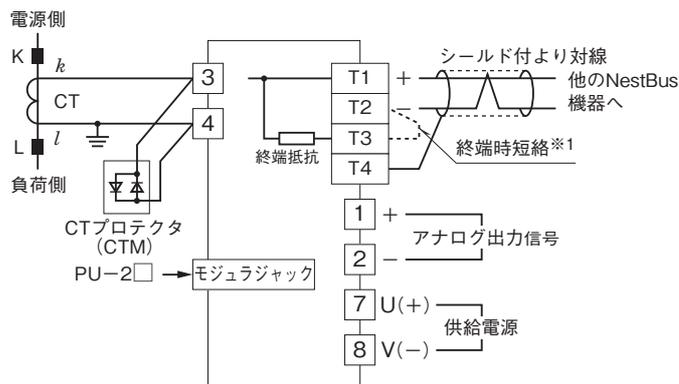
※1、より対線の伝送ラインが終端の場合は (= 渡り配線がない場合)、端子 T2、T3間を付属のショートチップ (または配線) で短絡して下さい。ユニットが伝送ラインの途中に配線されているときは、端子 T2、T3間のショートチップをはずして下さい。
